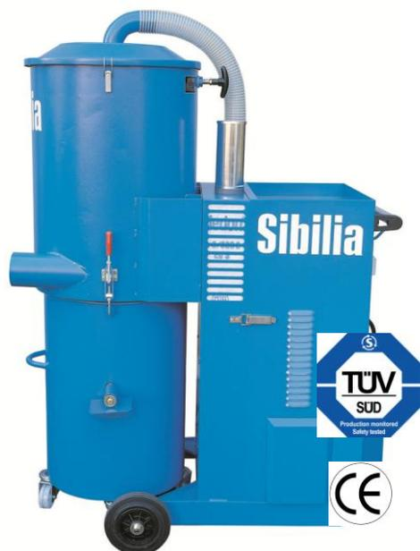
Промышленный пылесос средней мощности оснащен вихревым насосом. Насос находится у основания пылесоса и защищен стальной рамой. Он может быть оснащен главным карманным или рукавным фильтром с большой площадью фильтрации и подходит для сбора различных материалов, гранулированных и пылевидных. Стандартная версия пылесоса DS3000N оснащена картриджным фильтром класса М. При добавлении поплавкового датчика уровня пылесос может собирать жидкость.
