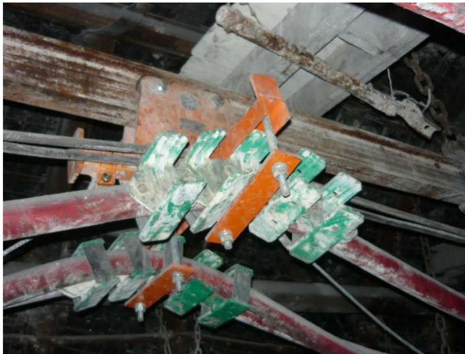
Тележка с частичным слоем кабеля и амортизаторами, предохраняющими кабелепроводы от механических повреждений в KWK Zofiówka, Ястшембе-Здруй.
