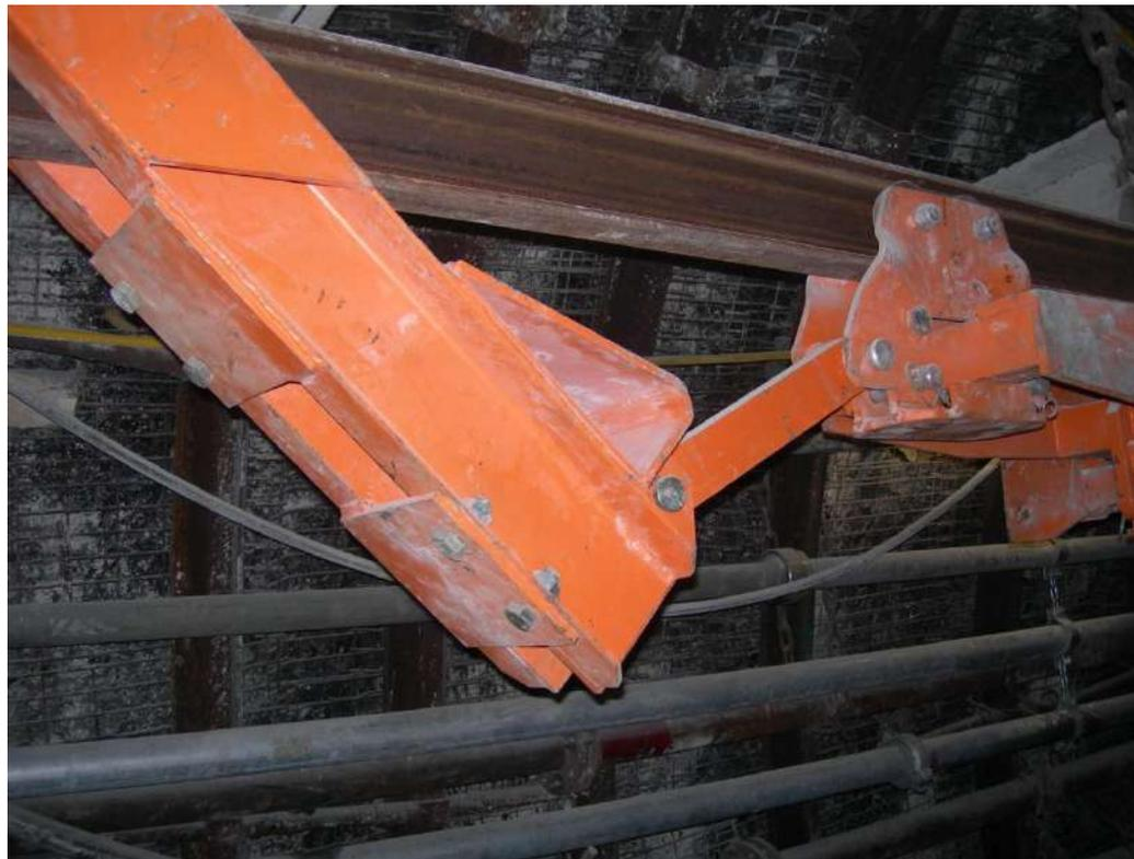
**Задний стопор, установленный в транспортной
