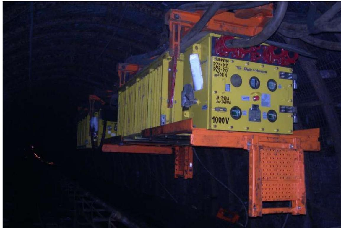
Трансформатор на двухтележной раме типа 20-60.4
