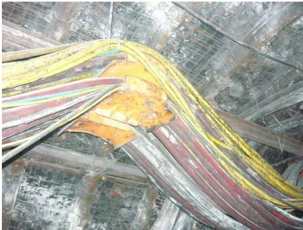
Тележка с держателем кабелей, обеспечивающим соответствующий радиус изгиба в KWK Zofiówka, Ястшембе-Здруй.
