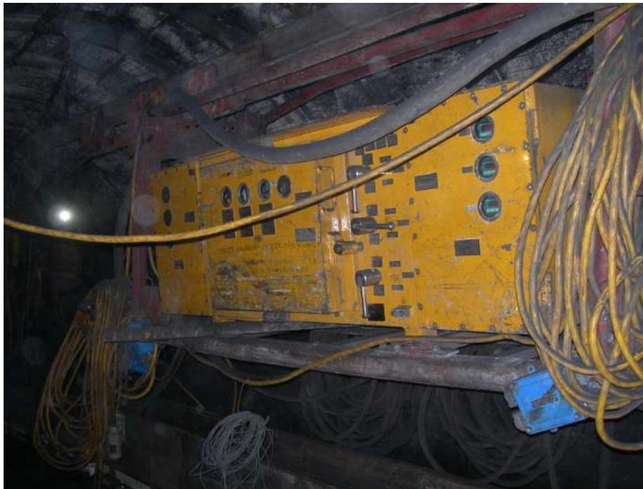
Компактная станция на поддоне типа 20-316
