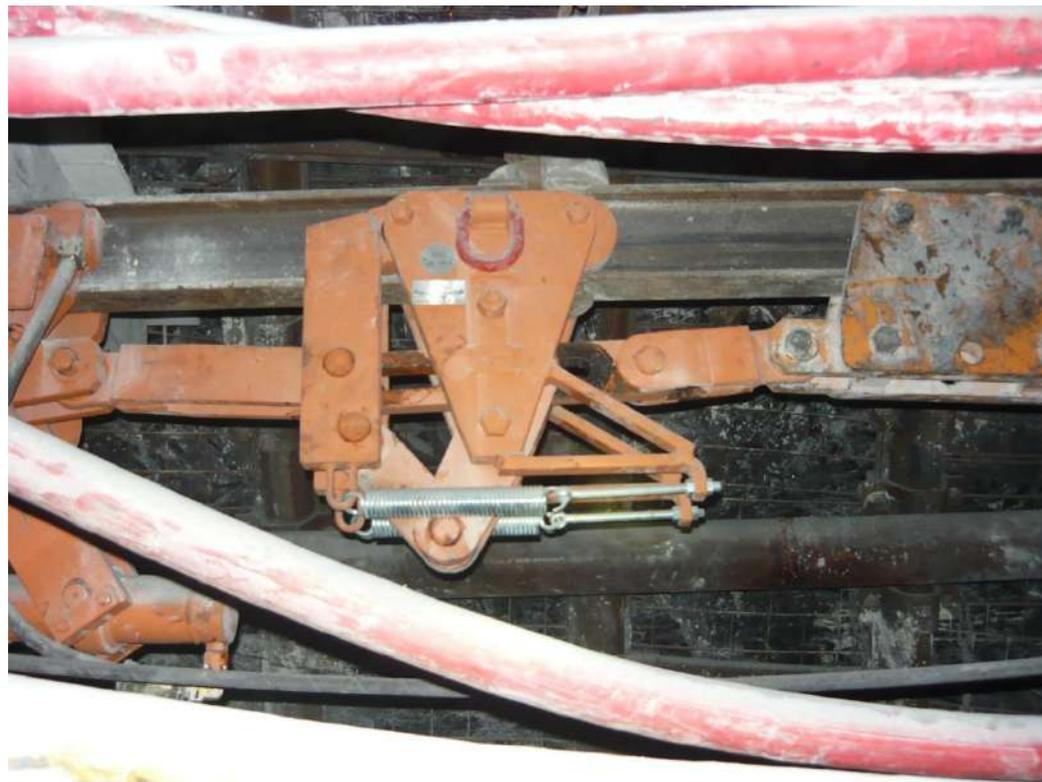
Передний стопор, установленный в транспортной системе в KWK Zofiówka, Ястшембе-Здруй.
