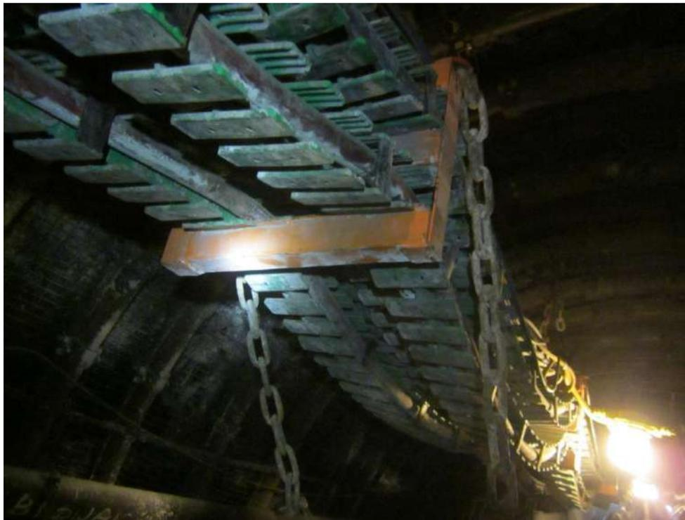
Тележки с держателями кабелеукладчиков и кабелеукладчики, предохраняющие кабеля от механических повреждений в KWK Zofiówka, Ястшембе-Здруй.
