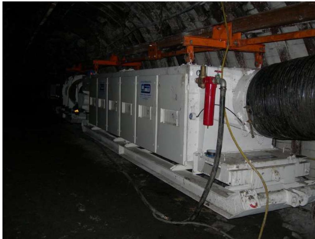
Оборудование для пылеподавления на тележках с удлинителем типа 20-364 (грузоподъемность 2x4000кг) в ZG Sobieski, Явожно.
