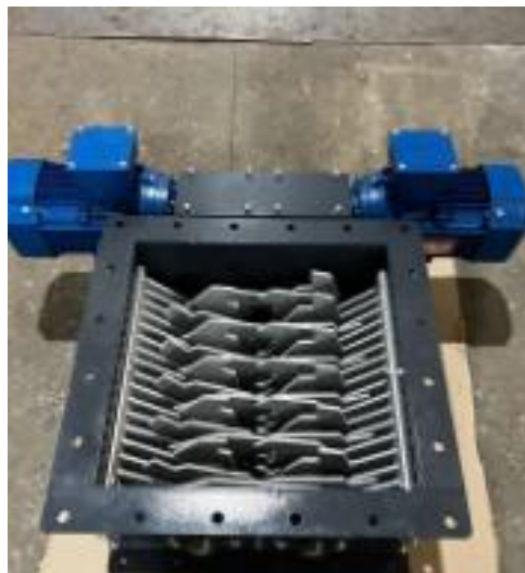
Рисунок 2. Устройство ДК - 400, где: 1 – Неподвижные ножи; 2 – Подвижные ножи; 3 – Мотор-редуктор; 4 – Корпус; 5 –Присоединительные фланцы
