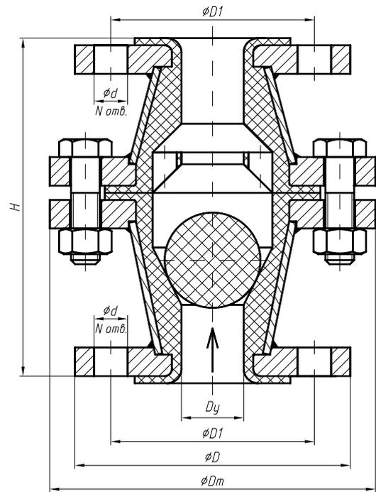
Клапаны обратные шаровые в броне предназначены для перекрытия потока среды в трубопроводе в случае появления противодавления.
