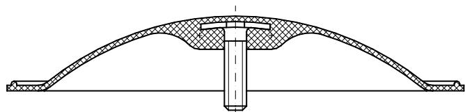
Мембранны предназначены для использования в мембранных клапанах типа КФМс футерованных защитным покрытием из фторопласта или полиэтилена. Мембранны обеспечивают герметичность в затворе и изоляцию внутренней полости клапанов от окружающей среды. Мембранны из Ф-4 выпускаются по чертежу М 80.02 с исполнительными размерами на следующие диаметры условного прохода: 15, 20, 25, 32, 40, 50, 80, 100 мм.
