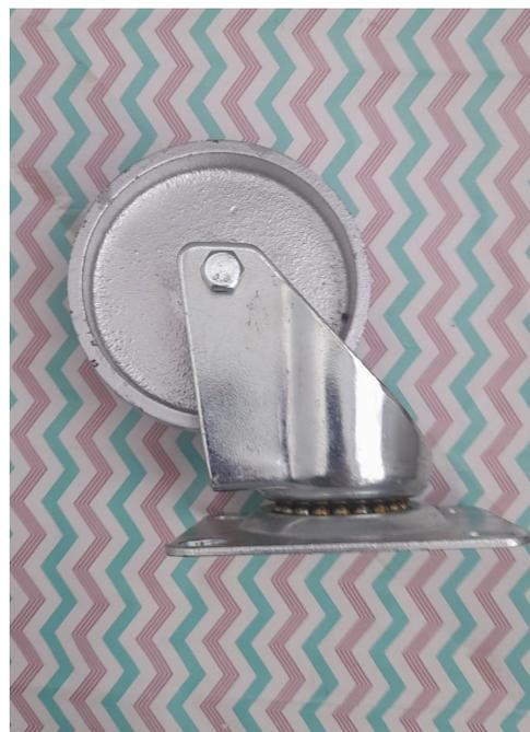
Детали поворотного кронштейна изготовлены прессованием из листовой стали. Поворотный узел содержит двухрядный радиально-упорный шарикоподшипник.
