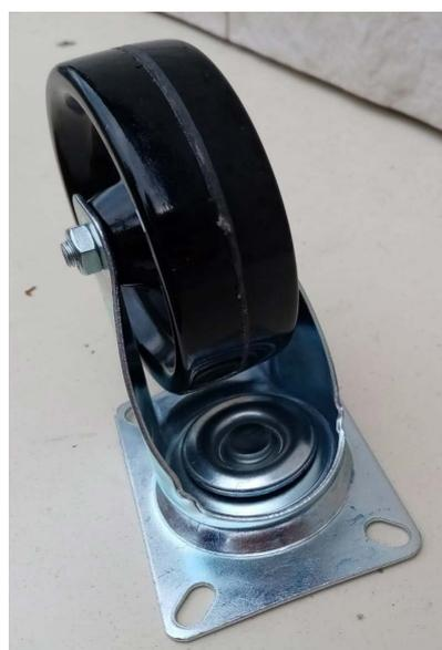
**Поворотные кронштейны из листовой стали средней серии для роликов транспортного оборудования:** Детали изготовлены прессованием из листовой стали. Поворотный узел содержит двухрядный шарикоподшипник, и скреплен стальной клепкой.
