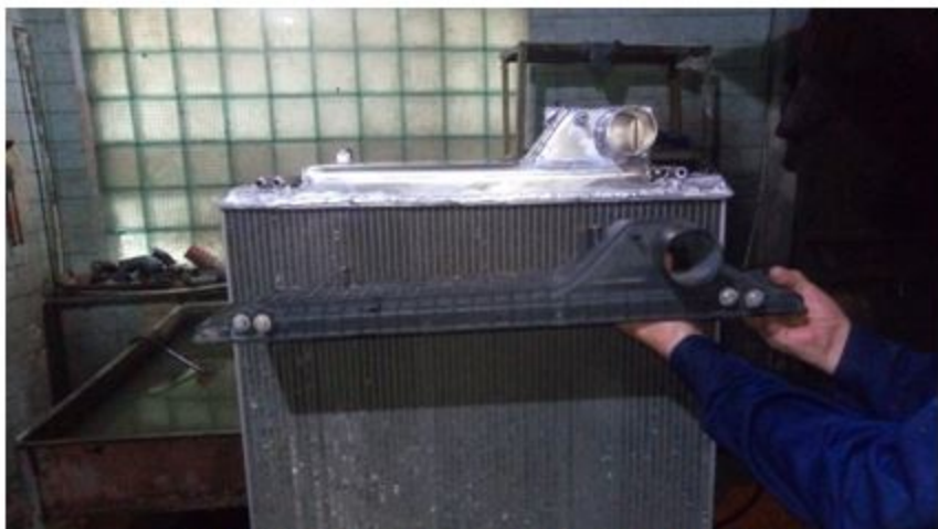
Изготовление алюминиевого бачка взамен пластикового
