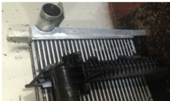
Изготовление алюминиевого бачка взамен пластикового
