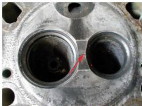
Устранение наружных и внутренних трещин
